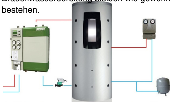
Abbildung 8 Schema eines Bestandspufferspeichers mit Frischwasserstation nach Anschluss der Nahwärme
