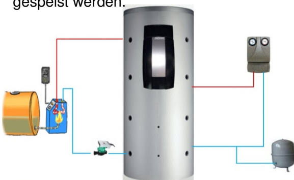
Abbildung 7 Schema einer Bestandsheizungsanlage mit Bestandspufferspeicher und Frischwasserstation
